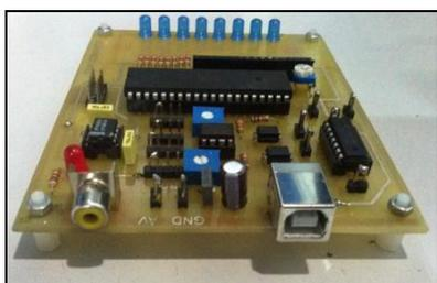
Gambar 3. Realisasi LED Meter Display
